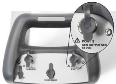
La potenza di uscita nominale del generatore di tracking dell'R&S ZVH è di 0 dBm.
