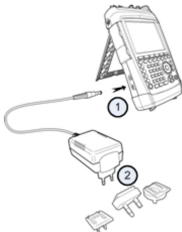
La gamma di tensione dell'alimentazione di corrente va da 100 V a 240 V di corrente alternata.
