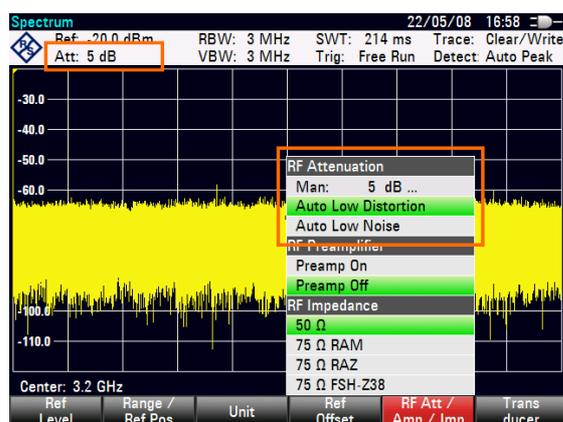
È possibile impostare l'attenuazione anche manualmente. L'R&S ZVH offre l'attenuazione in una gamma da 0 a 40 dB in incrementi di 5 dB.
