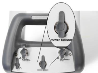
Il connettore è stato progettato soprattutto per essere collegato ai sensori di potenza. Viene utilizzato sia per alimentare che per trasferire i dati attraverso l'interfaccia del sensore di potenza.
